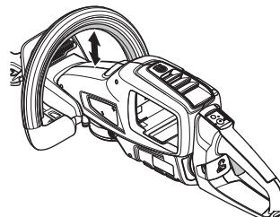
Затем нажмите переключатель питания вверх для включения на полную мощность.
